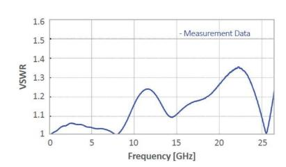
SMA Connector (P/N : PSF-S01-000~011)
